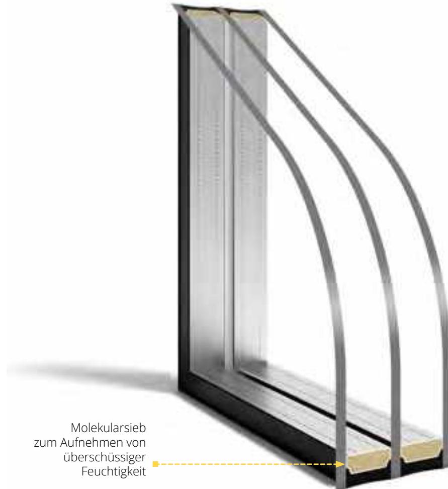
3-Scheiben-Paket (2 Kammern) 48 mm mit verzinktem Stahlrahmen zwischen den Scheiben.
