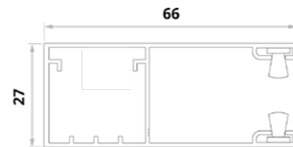
Einseitige Führungsschiene (für H55 Lamellen). PP6600
