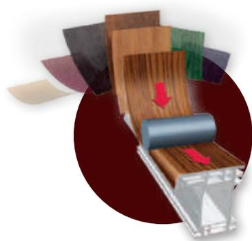
Schneller Wechsel von Dekorfolie und Profilgeometrie in der Produktion. Eine fast unbegrenzte Anzahl von Kombinationsmöglichkeiten eröffnet sich.
