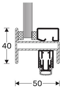
Die aufs Äusserste reduzierte Ansichtsbreite von Jansen Art'15, dem neu entwickelten, nicht isolierten Stahlprofilssystem von Jansen, ermöglicht ein einzigartiges Design, der Werkstoff Stahl gewährleistet eine lange Lebensdauer.
