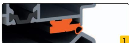
ZUSÄTZLICHE DICHTUNG AUS PVC DICHTET DEN ÜBERGANGSBEREICH ZWISCHEN TÜRFLÜGEL UND SCHWELLE AB
