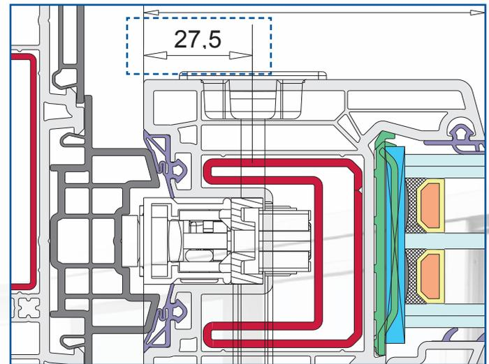
Für den Getriebebereich wurde eine spezielle Stahlverstärkung entwickelt, die für die einfache Integration von Profilylinder und Bedienebel eingerichtet ist.
