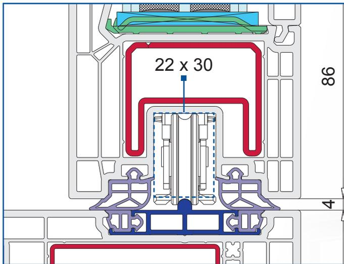
Laufwagen und Getriebe lassen sich sehr einfach von vorn in die Nute einsetzen. Wie von VEKA gewohnt, müssen für die Laufwagen keine Verstärkungskammern geöffnet werden.
